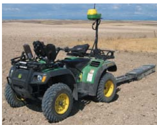
Figure 1 : Le quad équipé du système GPS et du capteur de conductivité qui génère la carte de conductivité pour la détermination des points de sondages.
