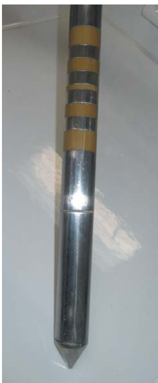
Figure 3 : L'extrémité de la sonde avec les différents capteurs.
