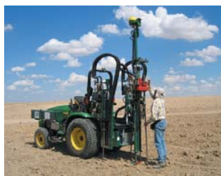
Figure 2 : Le tracteur en position pour la réalisation d'un sondage.
