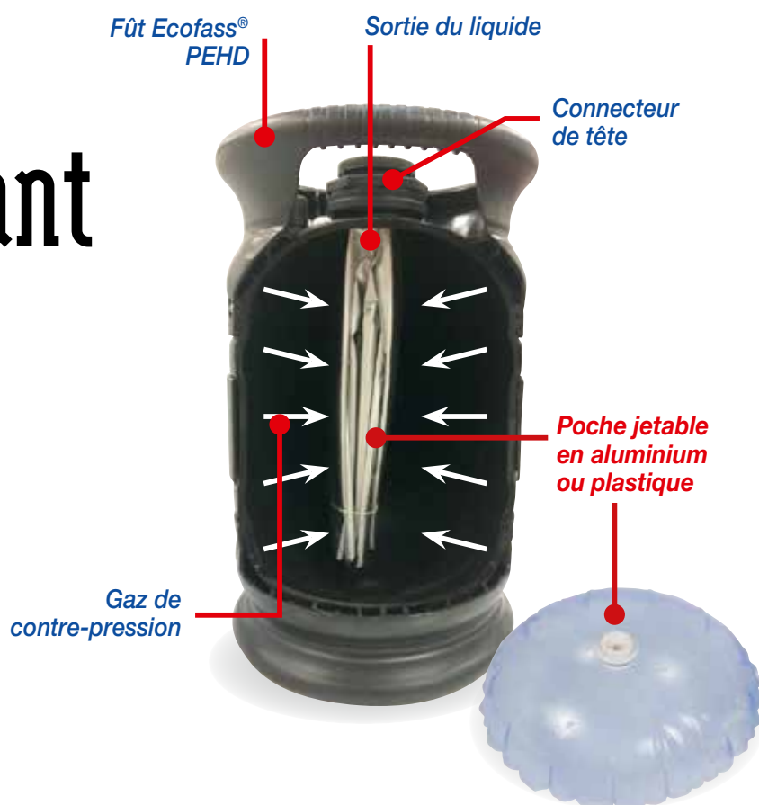
FIGURE 1 : LE FÛT ECOFASS® EST COMPOSÉ DE PLUSIEURS PARTIES POSSÉDANT DES PROPRIÉTÉS DIFFÉRENTES, POUR UN STOCKAGE ET UNE UTILISATION OPTIMAUX (Source : www.ecofass.com )
